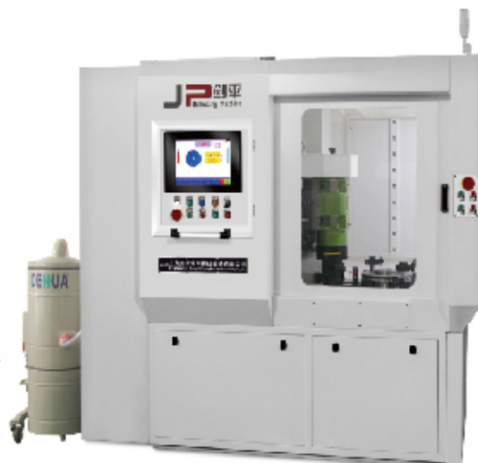
刹车盘全自动平衡机
